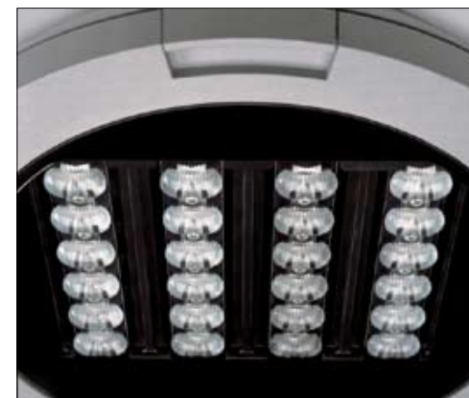
La lentille coiffant chacun des LED des luminaires urbains de la famille RL500 par We-Ef présente une grande similitude avec la courbe photométrique d'ensemble.
